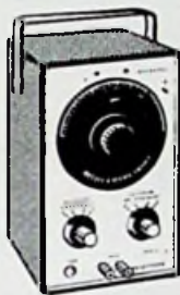
AG.71 Toongenerator, 20 Hz tot 200 kHz in 4 bereiken.
