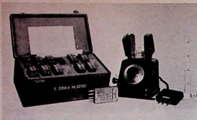
Afb. 1. Telefunken Audion communicatieontvanger uit 1921.
